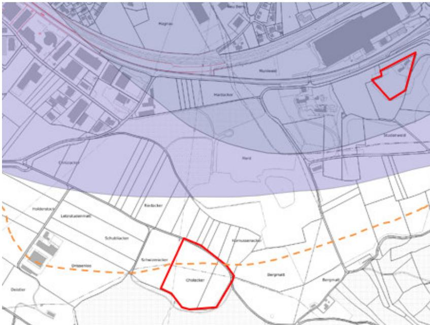
Abbildung 5.5 Grundwasserkarte mit eingetragenen Projektperimeter (rot) und neu interpolierte Grenze des Grundwassers (gelb).
